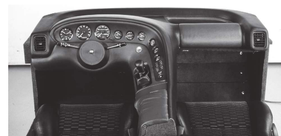
デザインコンセプトをもとに作成された 1/1 クレイモデル
