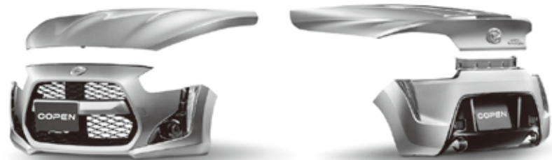
樹脂製のボディ外板（前後バンパー、ボンネットフード、トランクフード）
