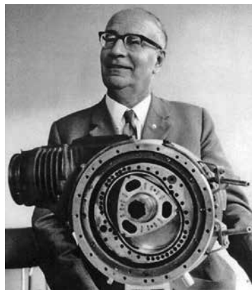
フェリックス・バンケルと1957年に製作されたDKM125型試作ロータリーエンジン。
