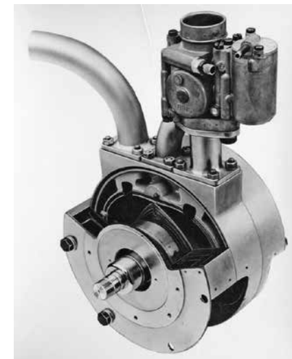
1957年に完成したKKM125型エンジン。後のロータリーエンジンの原型となったモデル。
