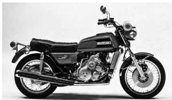
1974年、輸出専用車であったが、わが国で唯一ロータリーエンジンを搭載して量産されたスズキRE-5。
