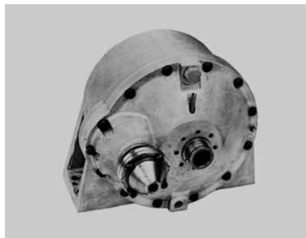
1956年、2輪のレコードブレイカー「バウムⅡ」の50ccエンジンに組み付け13psの出力を発揮した100ccのバンケル型スーパーチャージャー。
