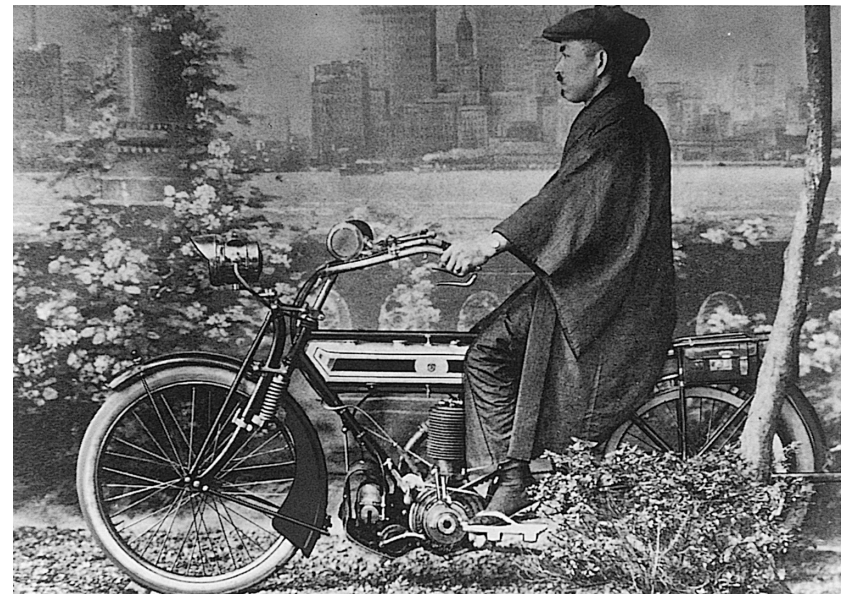
大正3年(1914年)の東京大正博覧会に出品された、宮田製作所のトライアンフ型・アサヒ号(4サイクル・3.5馬力)。売価は480円。第1号車は警視庁に納入され大隈重信総理大臣の護衛用に使用された。
