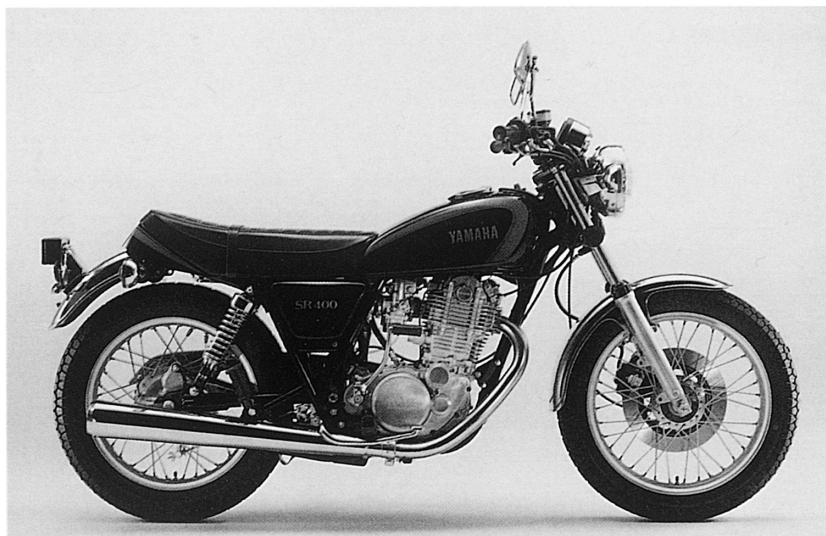
ヤマハSR400 (1978年・空冷4サイクル単気筒・OHC 398cc・最高出力27.0ps/7,000rpm・5速リターン・始動キック・車重158kg・価格31万円・ヤマハ発動機)。大排気量の国産単気筒の代表的な存在。時代に対応してホイール、キャブレター、ブレーキ等を変更しているが、大幅なモデルチェンジもされず量産されていたヤマハのロングセラー車。
