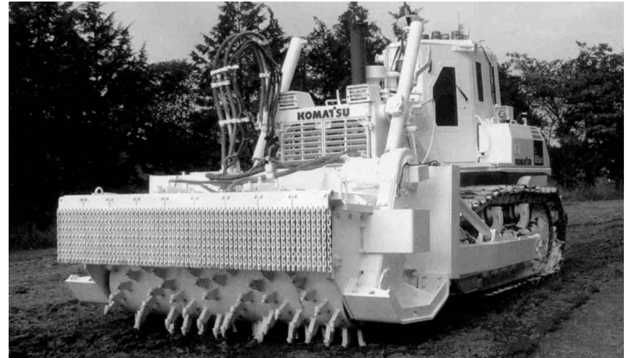
写真15-1 コマツD85MS-15対人地雷除去機（2007年）（コマツ所蔵写真）もともと頑丈なクロウラとブレードを持つ246馬力の大型ブルドーザを改良した、新しい建設機械の1種で5台生産されている。車体の前に着けた突起のあるローラで対人地雷を爆発させる。防弾運転室を備えるが、実際の処理作業はラジコンによる遠隔操作で行なう。
