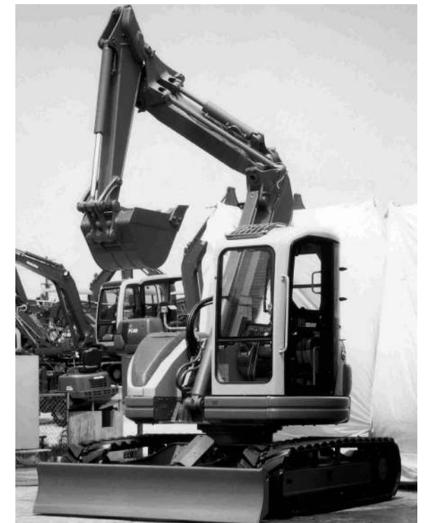
写真15-3 コマツPC75UU-2E超小旋回ミニショベル（1995年）（コマツ所蔵写真）回転半径を小さくして狭い道路で作業できるようにした油圧ショベルで、紫色塗装が国内外で大ヒットする。筆者がこのミニチュアをドイツに持っていき「仕事用の塗装でない」と怒られたが、フランスに持っていき「センスのよい建設機械だ」とショーケースに飾られ女性職員が集まる騒ぎになった。55馬力、車重7.9トンでバケット容量は0.29m 3 である。なお、このモデル以前の世界初の超小旋回型油圧ショベルPC28UUは1987年発売されている。
