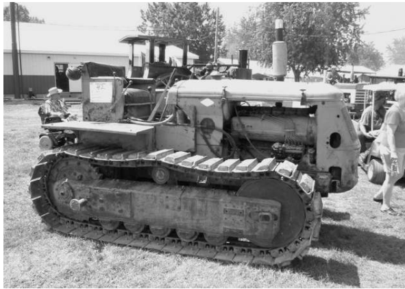
写真13-1 西独ドイツ (Deutz) 社DK75Bブルドーザ (1961年) (Jason T. Ryan氏所蔵) 同社製の空冷65馬力エンジンを搭載した中型ブルドーザである。アメリカでは、砂塵が舞う露天掘り鉱山などでは、空冷エンジンの耐久性が損なわれる問題があり、欧州以外には普及していない。
