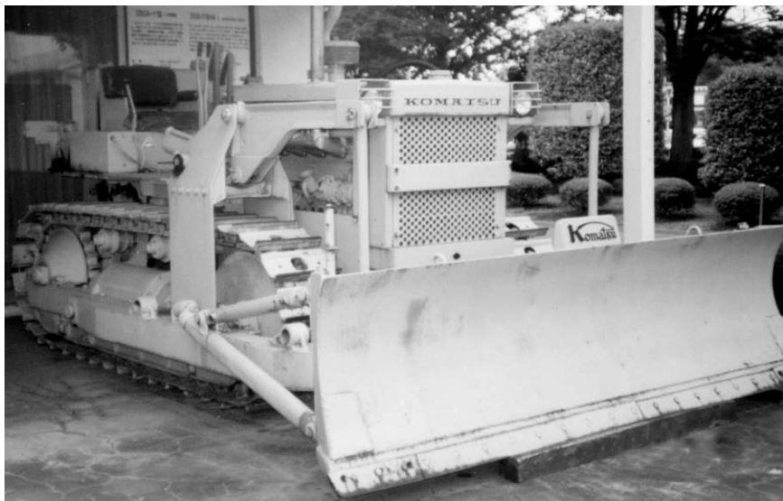
写真13-4 小松製作所D50A-11マルA車 (1963年) (コマツ小山工場所蔵) キャタピラー三菱社D4ブルドーザに対抗するため、オーバーホール時期を従来の3000時間からキャタピラー車並みの5000時間に「マルA対策」と称する活動が行なわれている。この対策では96台の試作車を作りボルト1本まで新規に作り直し耐久性と信頼性をアップしている。この話は米国経営学修士 (MBA) の教材にもなり世界的に有名である。
