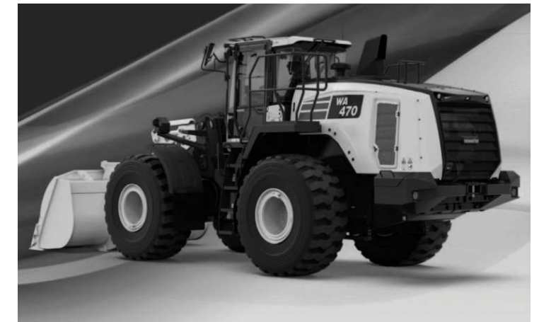
写真1-3 ホイールローダ (コマツ所蔵) コマツWA470-10型の例を示す。コマツ製11リッターディーゼルエンジン295馬力を搭載する。自動変速機に油圧駆動を組み合わせた無段変速のHMT (ハイドロメカニカル・トランスミッション) により、車両重量24.8トンの車体を速度3~38km/hで動かす。バケット容量は3.6~5.2m 3 と大きく4輪駆動で25°の登坂能力を持つ。掘削力は油圧ショベルよりも小さいが早いスピードで作業できる。
