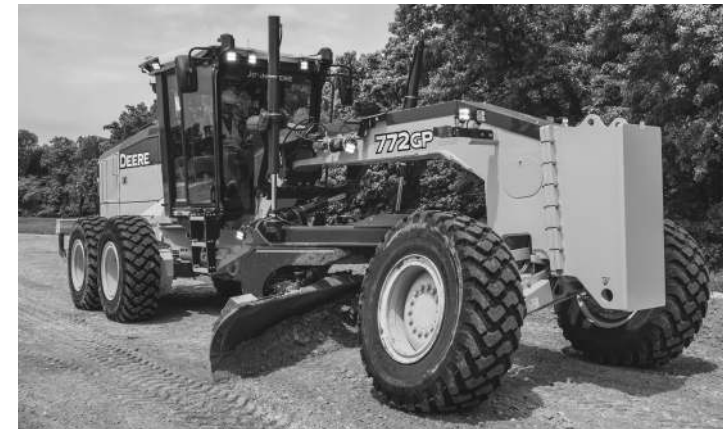
写真1-4 モータグレーダ (米ジョンディア社所蔵) ジョンディア社772GP型の例を示す。ジョンディア製9リッターディーゼルエンジン275馬力を搭載し、前進7速、後進7速の独自のHST (ハイドロスタティック・トランスミッション) により最高速度45.5km/hで走る。6輪駆動と4輪駆動の2形式があり、重量25トンで3.7mの長さのブレードで土を均すことができる。後車体後部にはスカリファイアと言う3本爪の掘削装置を付けている。ブレードで地面を削る時に、車体がブレードからの力で左に曲がるため前輪を傾けて (リーニングと言う) 直進する。
