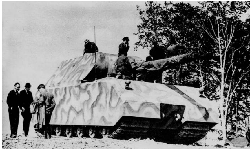
写真11-4 独フェルディナント・ホルシェ設計の Maus 戦車タイプ205 (1944年) 113) ガソリンエンジンと直結した直流発電機でモーター駆動する試作戦車で1750馬力、188トンという大きさであるが実用性がないため2台の試作に止まる。これらにはジューペンの潜水艦や電気シヨベルなどの技術が利用されている。
