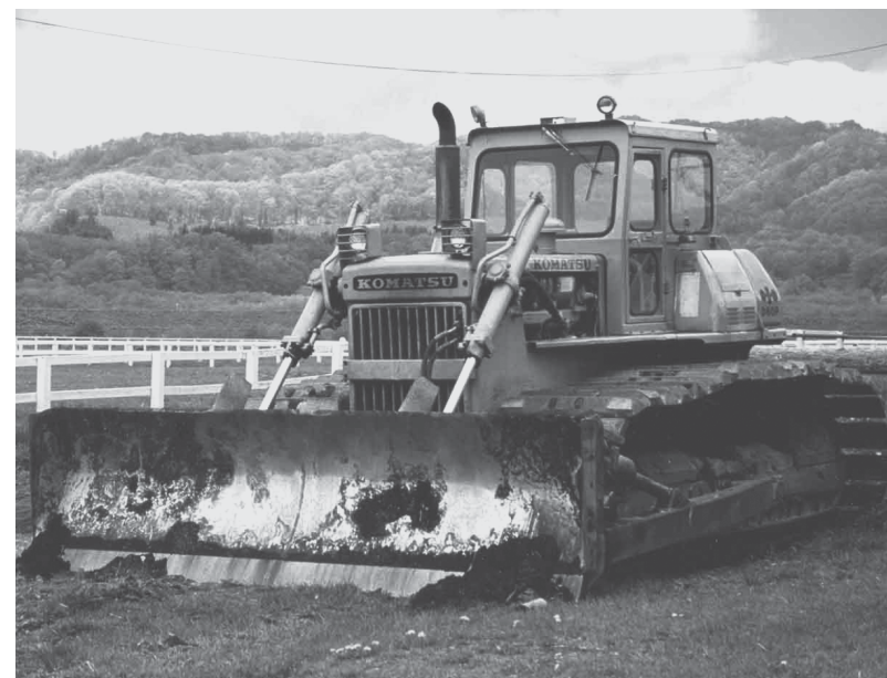
コマツ D60P-6ブルドーザ (1970 年式、高松武彦氏所蔵写真) 155 馬力、重量 17 トン 従来の機種に比べて 1.6 倍の土砂を押す性能があったベストセラー車である。他機種が 3 ~ 4 回モデルチェンジする間も、この機種はそのまま改良もせずに他を圧倒する性能であったと設計者で本書の推薦者でもあった高松氏は述懐した。車両の姿に設計者の自信がにじみ出ているような気がする。
