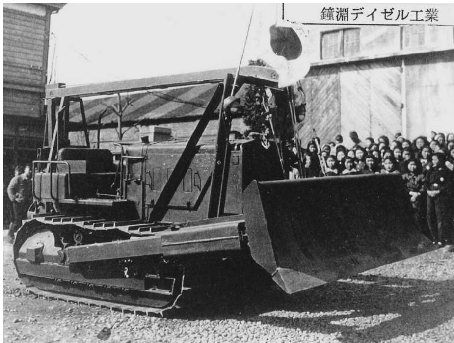
写真11-5 鐘淵ダイゼル工業7.5トン押均機 (1943年) (日産ディーゼル所蔵写真 (平野宏氏提供)) 性能が良いブルドーザと評価が高い。独ユンカース社特許に基づく3気筒垂直対向ピストンエンジン (写真10-4参照) 90馬力を搭載して、重量は10.3トンである。この他に5トン、15トンの押均機があった。戦時中は鐘淵紡績の工場で約150台が製造され、戦後も一時生産されたが占領軍 (GHQ) により生産中止させられている。押均機は海軍の呼称である。
