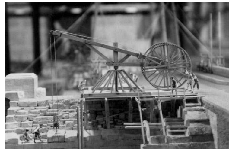
写真2-5 仏セヌ川工事の人力クレーン (1768年) (Deutsches Museum 所蔵) 写真2-4と同じ現場で使用されたクレーンである。ここでは、人が車輪の中に入って駆動する大型クレーンも使われている。
