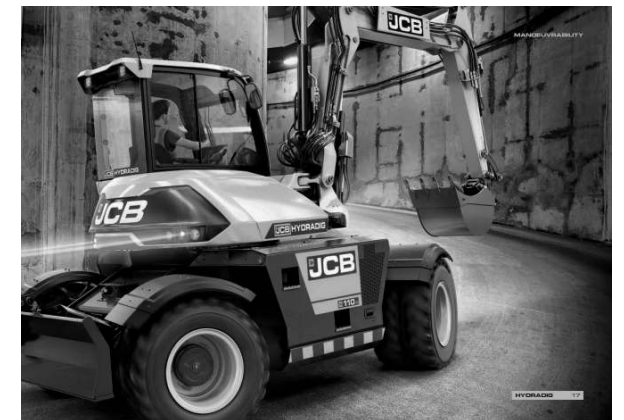
写真16-6 英JCB社ハイドラディック110Wホイール式油圧ショベル (2016年) (JCB社所蔵) 4.4L、109馬力のJCB製EcoMAXエンジンを車体下部に積み、油圧駆動 (HST) で重量11トンの車体を速度40km/hで走らせる。全輪操舵式で狭い場所でも小回りが利く。エンジンや油圧駆動部は下部車体にあるので安定性が高く、視界が良いのが特徴である。バケット容量は0.25m 3 と小さい。
