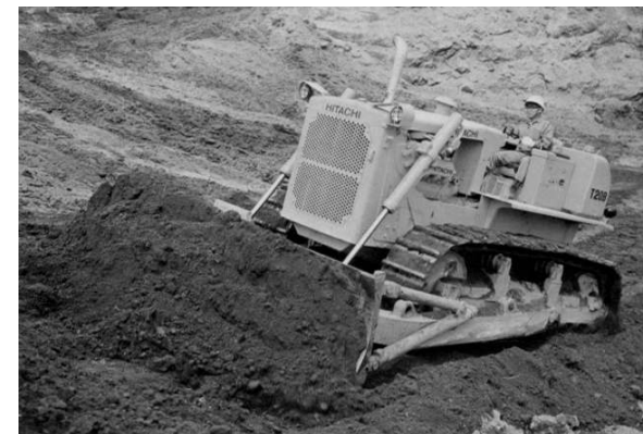
写真13-7 日立製作所T20Bブルドーザ (1968年) (日立建機所蔵) 同社最大のブルドーザで車重20.2トン、185馬力の自社製ディーゼルエンジンを搭載している。
