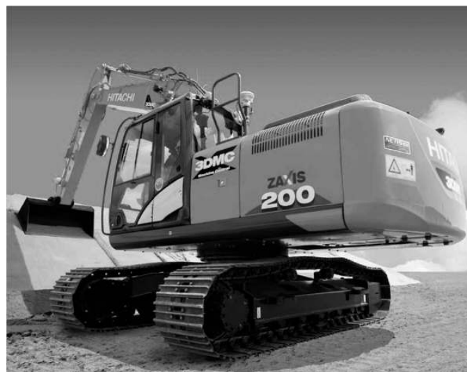
写真1-1 油圧ショベル (日立建機所蔵) 日立建機ZX200X-6の例を示す。いすゞ自動車製5.2リッター・ディーゼルエンジン175馬力により、油圧駆動で重量20.7トンの車体と容量0.8m 3 のバケットを動かす。油圧による強力な掘削力に加え、情報通信技術 (ICT) により3次元 (3D) 設計データに基づいて半自動で高精度掘削ができる。居住性は乗用車並みである。左右クローラを逆回転させてスピターン (超信地旋回) もできる。
