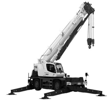
写真1-5 ラフテレーンクレーン (タダノ所蔵) タダノCREVO GR-250N G4の例を示す。米カミズ社製6.7リッターの273馬力ディーゼルエンジンと自動変速機により重量26トンの車体を最高速度49km/hで走らせる。未舗装の現場や狭い場所にも入れるように4輪駆動であり、4輪操舵により回転半径は小さくできる。ブームは4段の伸縮式で長さ30mまで伸びる。ブーム横に装着されているジブ (腕) を伸ばすと45mの高さに達する。吊り荷は最大で25トンである。クレーン使用時には車体の前後左右4本のアウトリガー (油圧シリンダ式安定脚) を広げて、転倒を防ぐ。
