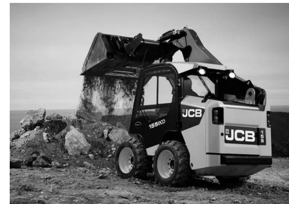
写真16-5 英JCB社280スキッドステアローダ (2010年) (JCB所蔵) 84馬力、重量8.1トンでバケット容量0.47m 3 である。一般的なSSLは運転席の両側にリフトブームがあるため、乗降するのが面倒であり、作業時には視界がブームで遮られる問題がある。このSSLはJCB社独自の片側1本のブームでバケットを支えているため、乗降が容易になり視界も良い特徴がある。
