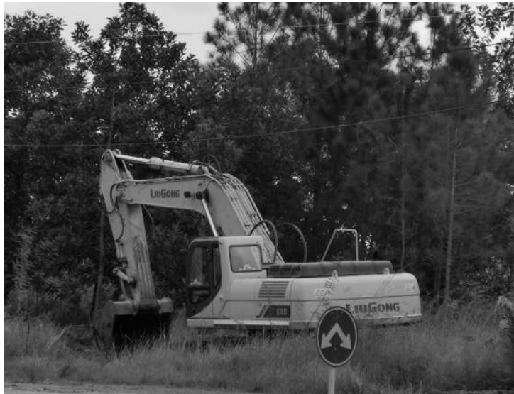
写真16-1 中国広西柳工機械社 (LiuGong) 936D 油圧ショベル (2011年) (筆者撮影) 2020年売上げ世界19位の国有企業の油圧ショベルである。重量37トン、280馬力である。ホース配管が雑で稼働年数約3年の割に劣化があるように見える。
