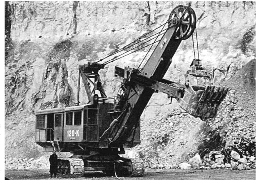
写真11-8 神戸製鋼所120-K電気シヨベル (1942) (神戸製鋼所所蔵) 米ビサイラス社製を参考として日立製作所の120-Hと共に開発された。バケット容量は3.0m 3 、重量120トンと大きく南満洲鉄道の撫順炭鉱向けである。米国製よりも性能が良いと採用されたが、戦時中のワイヤロープの品質の悪さには悩まされたようである。
