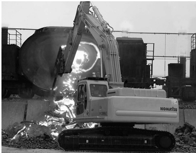
コマツ不燃性作動油仕様PC300LC-6 油圧ショベル（2000年式、筆者撮影）230馬力、重量32トン製鉄所から出る1200℃の鋳滓（スラグ）を掻き落とす専用の油圧ショベルである。車両火災を生じないために、筆者らが水40%を配合した不燃性作動油を使用できる様に改良した世界初の油圧ショベルである。先進的な技術を注ぎ込んだが、残念ながらわずか数台しか売れなかった。全力を尽くした思い出の機種である。
