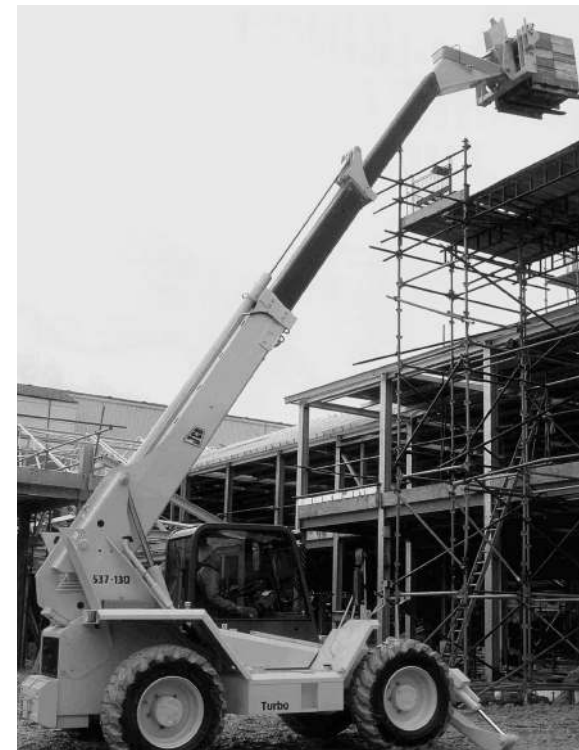
写真15-2 英JCB社537ロード・テレスコピック・ハンドラー（1994年）（JCB所蔵写真）106馬力エンジンを搭載し、7トンの荷を12mの高さまで上げることができる。欧米では良く使われ始めているが日本では殆ど使用されない。コマツ、米キャタピラー社、米ケース社、米ボブキャット社、独リープヘル社なども生産している。
