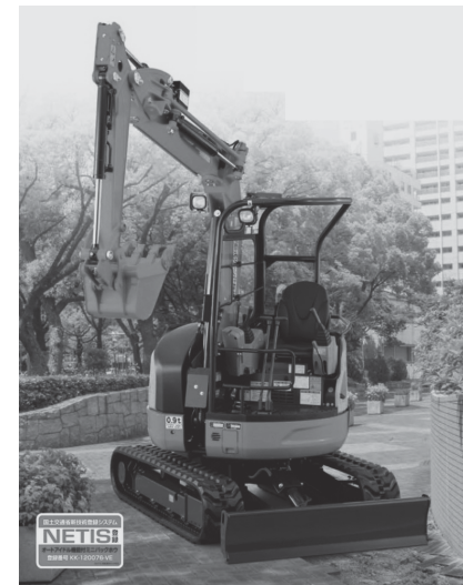
写真1-2 ミニショベル (クボタ所蔵) クボタのRX-306E型の例を示す。26馬力のクボタ製3気筒ディーゼルエンジンにより、油圧駆動で重量3.2トン、容量0.09m 3 の小型バケットを動かす。都市部の狭い現場でも作業できるように、バケットブームを運転席横に装着して掘削する超小旋回タイプである。
